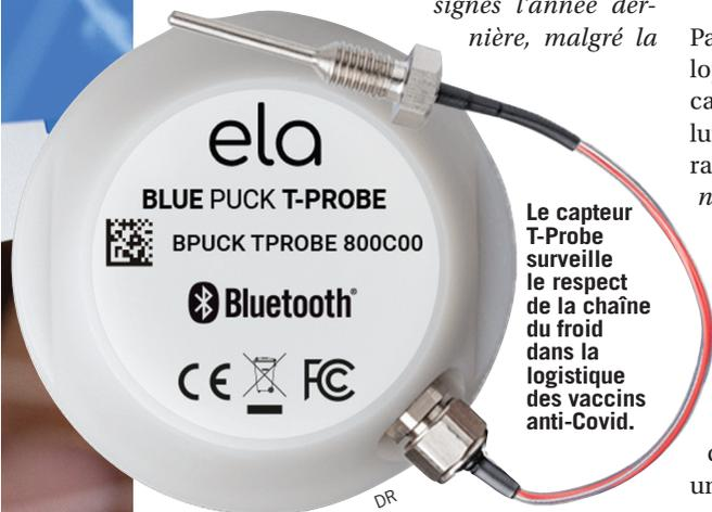
Le capteur T-Probe surveille le respect de la chaîne du froid dans la logistique des vaccins anti-Covid.
